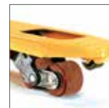
Tandem-Rollen 2 Rollen in jeder Gabel wippend gelagert. Vorteilhaft bei unebenen Böden und Überfahren von Kanten und Schwellen. Kletterrollen an den Gabelspitzen.
